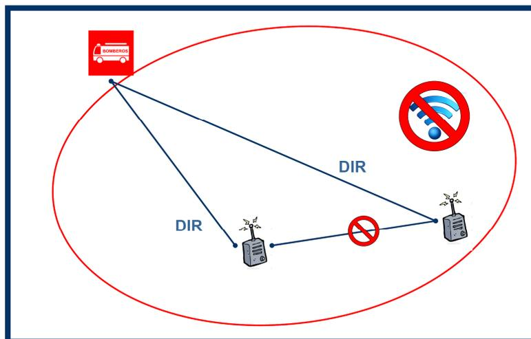
Repetidor activado, ampliando localmente la cobertura, independientemente de la cobertura de red, enlazando dos grupos de emisoras que no pueden comunicarse directamente, trabajando en el mismo canal de directo que el repetidor.
