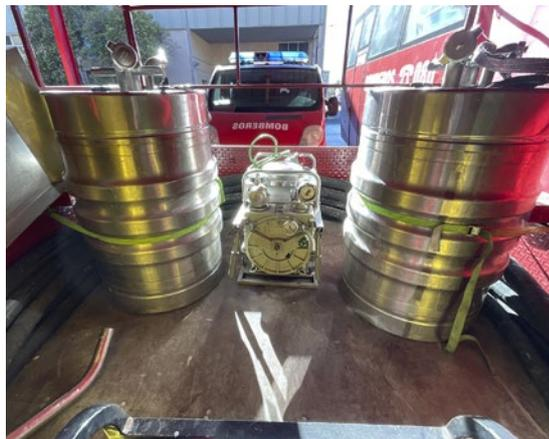
▲ Depósitos para bomba peristáltica.
